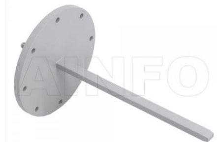
28EWGK + オープンエンドプローブ Freq 26.5- 40GHz Gain, Typ 5 dB 3dB BW, E Typ 88 Deg. 3dB BW, H Typ 58 Deg. Cross Pol Iso Typ 35dBc Length 194mm Connector K-F
