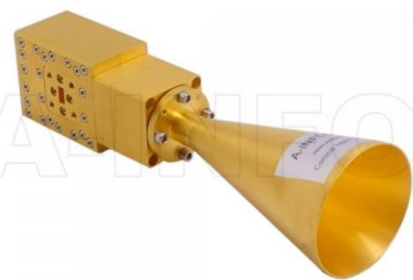
LB-CH-28-20-T68-C-2.4F + Dualリニアコルゲートコニカルホーン Freq 24- 50GHz Gain, Typ 20 dB 3dB BW, E Typ 14 Deg. 3dB BW, H Typ 14 Deg. Cross Iso Typ 40 dBc Power CW 10 W Connector 2.4mm-F
