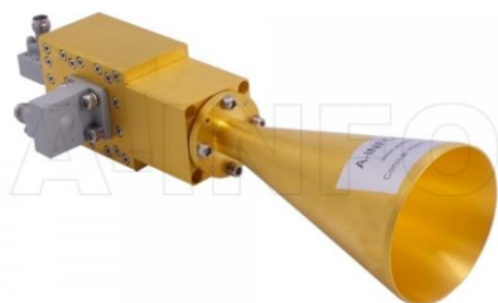
LB-CNH-28-20-T63-C-2.4F + Dualリニアコニカルホーン Freq 23- 44GHz Gain, Typ 20 dB 3dB BW, E Typ 12 Deg. 3dB BW, H Typ 15 Deg. Ports Iso Typ 50 dBc Power CW 10 W Connector 2.4mm-F
