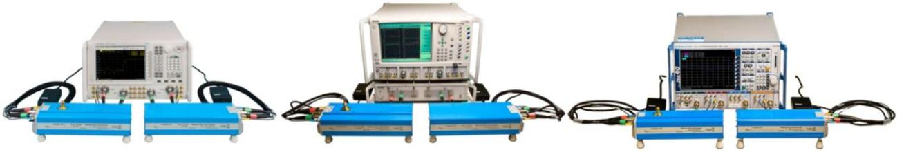
VNA周波数拡張モジュールはキーサイト、アンリツ、ローデンスワルツ製のVNAに接続し50GHz~500GHzへ周波数測定レンジを拡張することが可能
